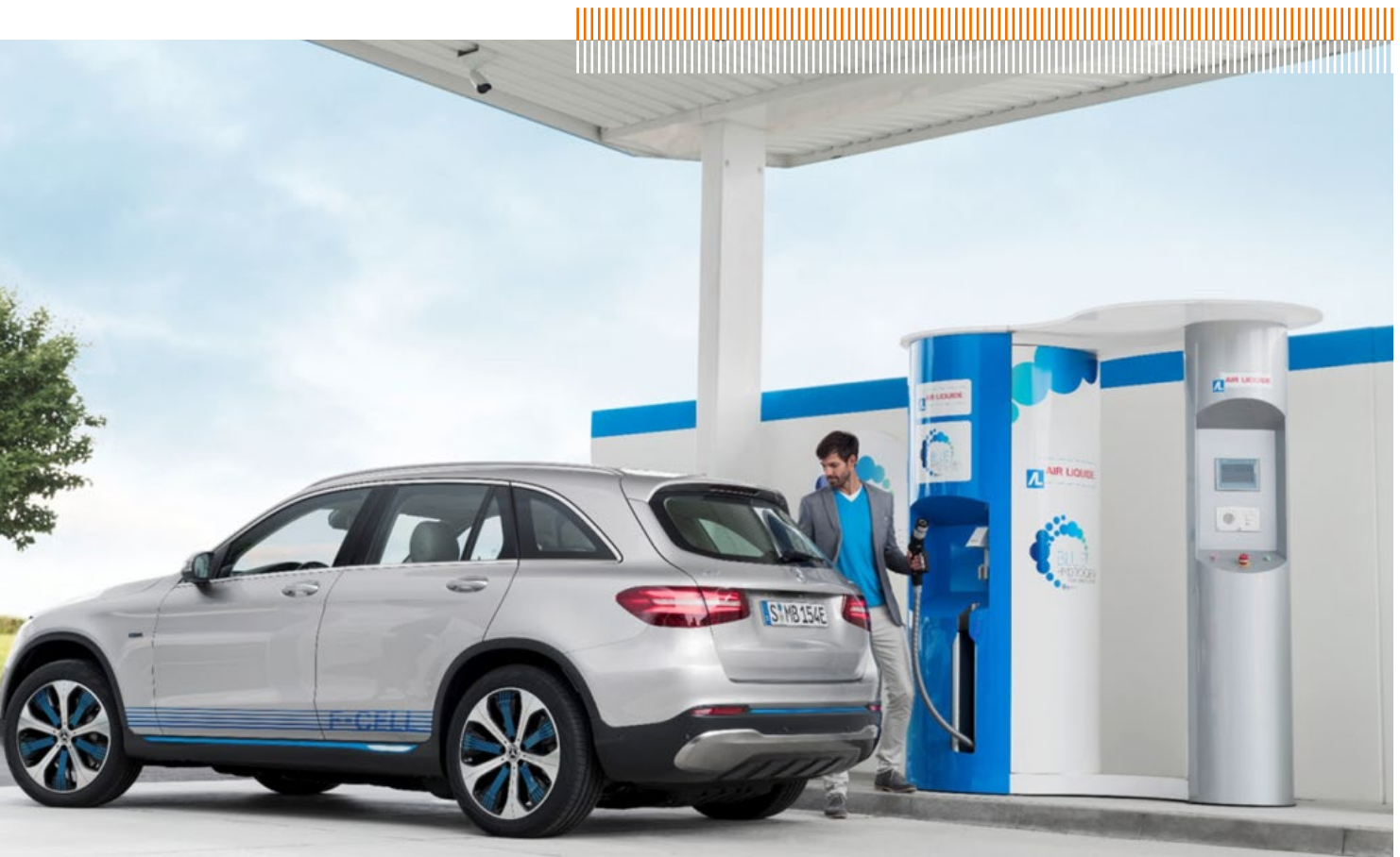
Mercedes Benz GLC F-Cell (Vorserie, 147-kW-Elektroantrieb, Li-Ion-Batterie mit 13,8 kWh Energieinhalt, Druckwasserstoff-Speicher (700 bar) mit 4,4 kg Wasserstoff)
