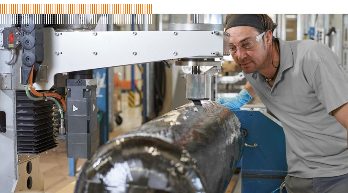
Produktion eines CFK-Behälters bei EMS am Standort Jülich
