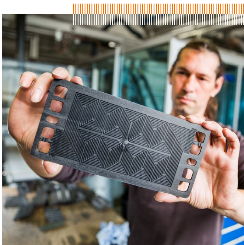
Spritzgegossene Bipolarplatte für HT-PEFC
